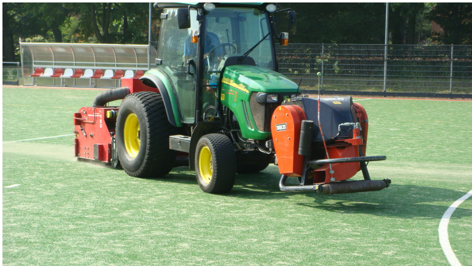
Foto 2: Reinigen dmv Vertitop op zand ingestrooid hockeyveld Amsterdam
