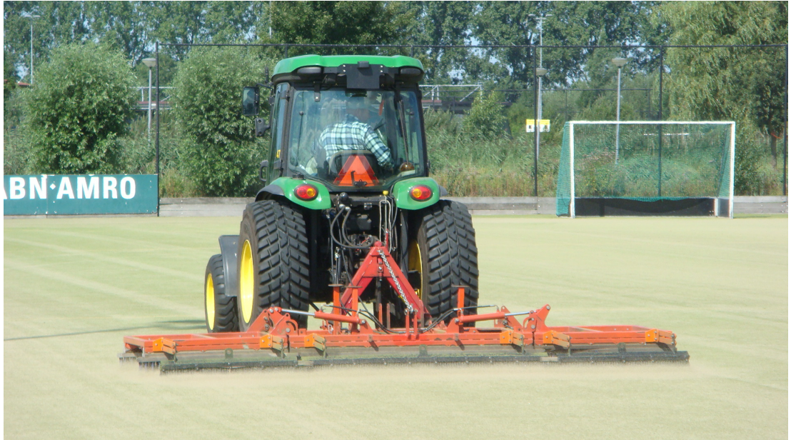
Foto 1: Borstelen zand ingestrooid hockeyveld Rotterdam
